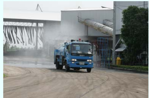
การฉีดน้ำดักฝุ่นไม่ให้ฟุ้งกระจาย
